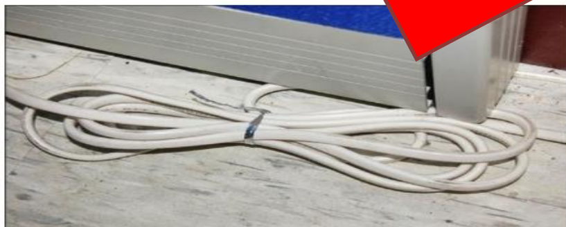
延長線擠壓造成變形
