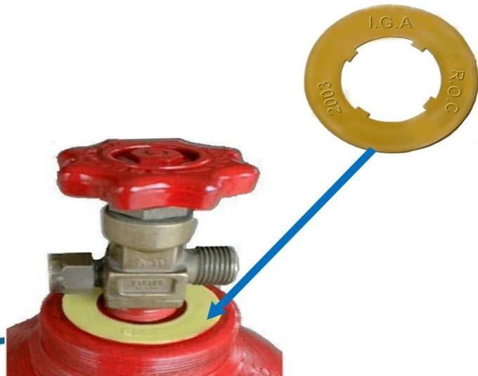
鋼瓶水壓檢驗合格識別環位置圖
