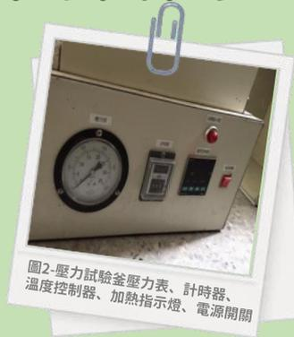
圖2-壓力試驗釜壓力表、計時器、溫度控制器、加熱指示燈、電源開關
